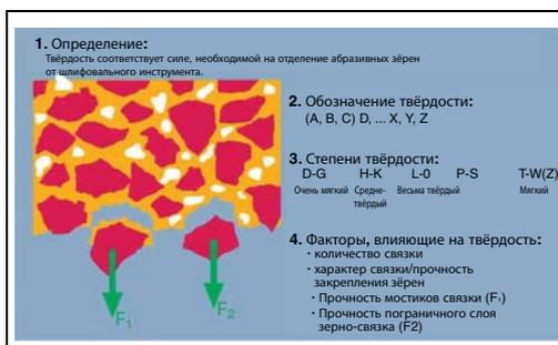
Рис. 11.12 Твёрдость шлифовального круга
