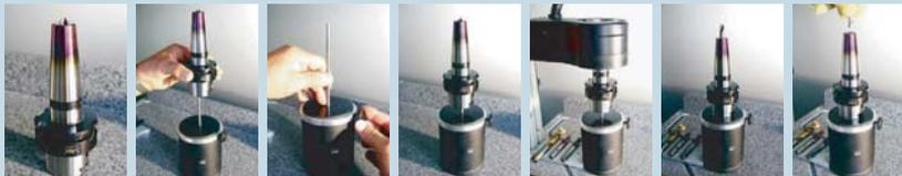
Обломок - хвостовик в патроне | Определить длину необходимой длины выталкивателя | Отрегулировать длину выталкивателя (до упора + ок. 2 см) | Установить патрон с обломком на выталкиватель | Нагреть патрон | Как только патрон достигнет необходимой температуры, он упадет на предохранительную подкладку | Обломок инструмента можно легко извлечь
