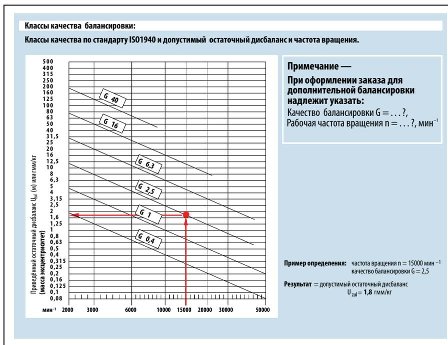
Рис. 10.18 Допустимый остаточный дисбаланс и рабочая частота вращения в зависимости от классов качества по стандарту DIN ISO 1940
