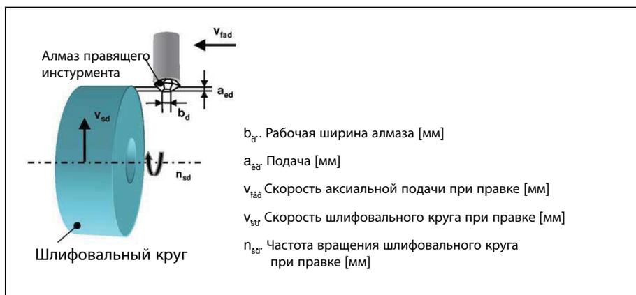
Рис. 11.26 Условия врезания при правке неподвижным инструментом
