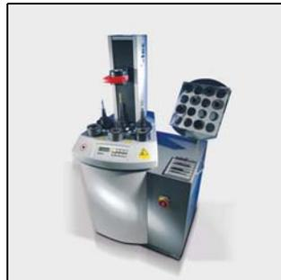
Рис. 10.5 Автоматизированный прибор для термозажима KELCH i-tec XL
