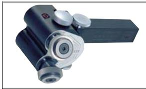
Фрезерование рифлений представляет собой профилирование шабрением с подачей вращающегося инструмента, снабженного зубьями с острыми краями (накатки). При фрезеровании рифлений не образуется наклёп. Стружка снимается обкатыванием от основания к вершинам зубьев (соскребаётся).
