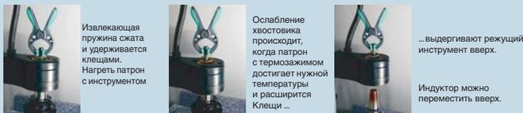
Извлекающая пружина сжата и удерживается клещами. Нагреть патрон с инструментом | Ослабление хвостовика происходит, когда патрон с термозажимом достигает нужной температуры и расширится. Клещи ... | ... выдвигают режущий инструмент вверх. | Индуктор можно переместить вверх.
