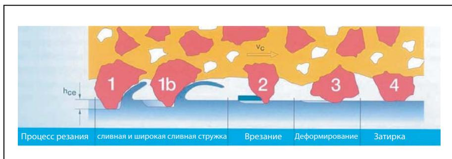
Рис. 11.3 Механизмы съёма материала при шлифовании металлов
